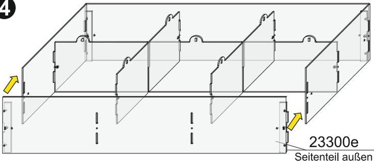
Jetzt werden die beiden Seitenteile ( außen ) 23300e befestigt und zusätzlich an den Eckleisten verschraubt.
