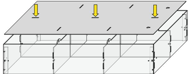
Abschließend wird die Rückwand 23300a aufgelegt und mittels Keilen fixiert. Sollen mehrere Regale nebeneinander aufgestellt werden, können sie mit Hilfe der längeren M3 Schrauben verbunden werden.
