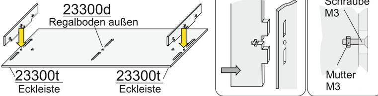
Die Eckleisten 23300t werden in den Regalböden 23300d gesteckt und mittels Schrauben und Muttern ( M3 ) fixiert. ( alle Schrauben bitte nur leicht anziehen )
