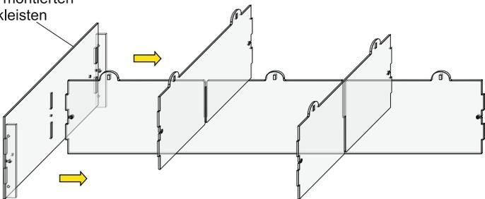
Die beiden fertig montierten Regalböden ( außen ) 23300d, werden nun an das Seitenteil 23300b gesteckt und mittels Schrauben und Muttern ( M3 ) fixiert.
