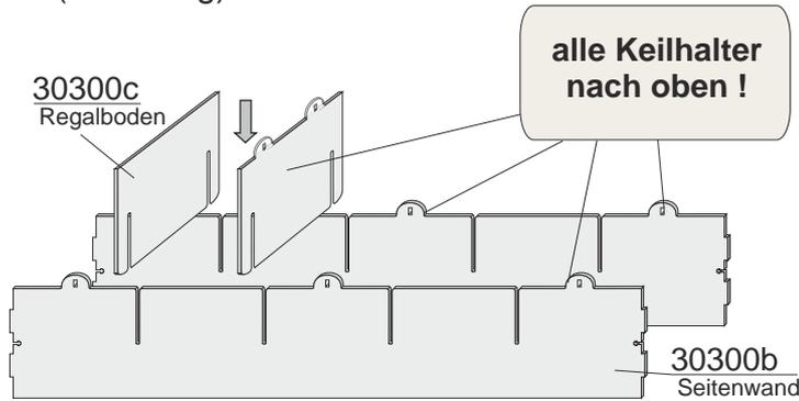
Die Regalböden 30300c und 30300e (zwei von jeder Sorte) werden in die Seitenwände 30300b gesteckt, dabei müssen die Keilhalter oben sein.
