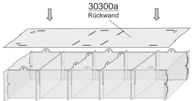
Abschließend wird die Rückwand 30300a angelegt und mittels Keilen fixiert.
