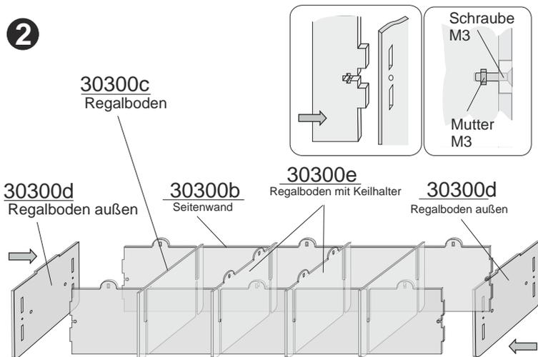
Die beiden Regalböden ( außen - 30300d) werden nun an die Seitenwände (30300b) gesteckt und mittels Schrauben und Muttern (M3) fixiert. Schrauben nur leicht anziehen! Beim Einstecken der Muttern ist auf die richtige Lage zu achten, siehe Skizze unten.
