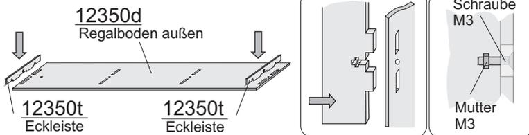
Die Eckleisten 12350t werden in den Regalboden 12350d gesteckt und mittels Schrauben und Muttern ( M3 ) fixiert. ( alle Schrauben bitte nur leicht anziehen )
