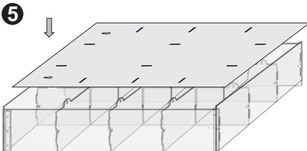
Abschließend wird die Rückwand 12350a aufgelegt und mittels Keilen fixiert. Sollen mehrere Regale nebeneinander aufgestellt werden, können Sie mit Hilfe der längeren M3 Schrauben verbunden werden.
