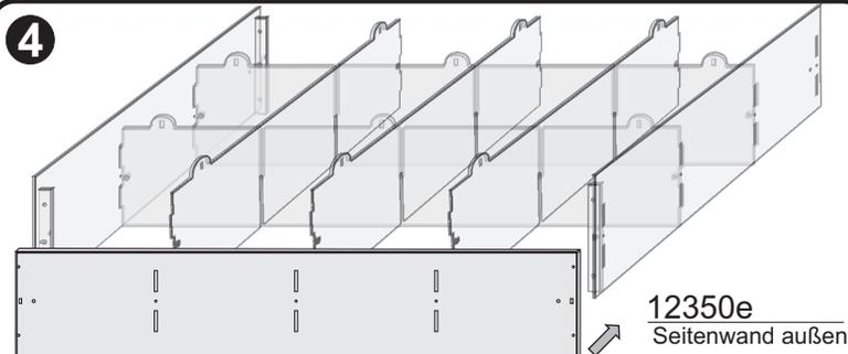
Jetzt werden die beiden Seitenwände ( außen ) 12350e befestigt und zusätzlich an den Eckleisten verschraubt.
