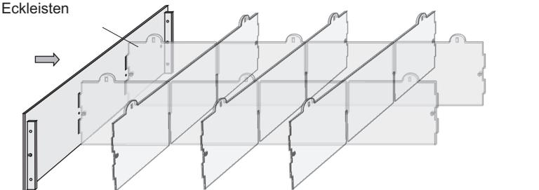
Die beiden fertig montierten Regalböden ( außen ) 12350d, werden nun an die Seitenwände 12350b gesteckt und mittels Schrauben und Muttern ( M3 ) fixiert.
