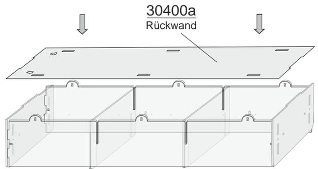
Abschließend wird die Rückwand 30400a angelegt und mittels Keilen fixiert.
