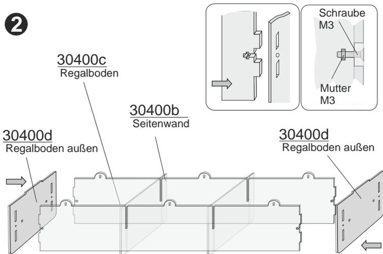
Die beiden Regalböden ( außen - 30400d) werden nun an die Seitenwände (30400b) gesteckt und mittels Schrauben und Muttern (M3) fixiert.
