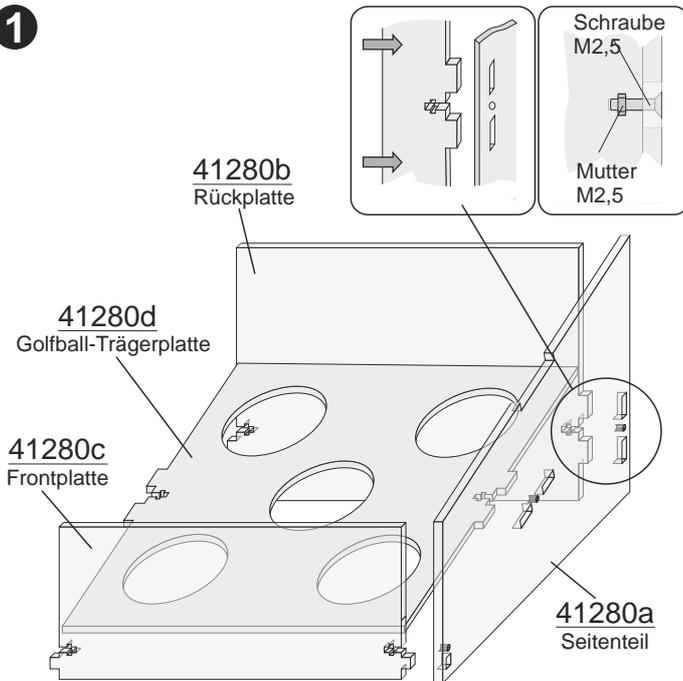
Stecken Sie zunächst die Rückplatte 41280b in das Seitenteil 41280a ein. Achten Sie dabei darauf dass die Senkungen der Löcher nach außen zeigen. Verwenden Sie die kleinen M2,5 Senkkopfschrauben um die Rückplatte fest mit dem Seitenteil zu verbinden.
