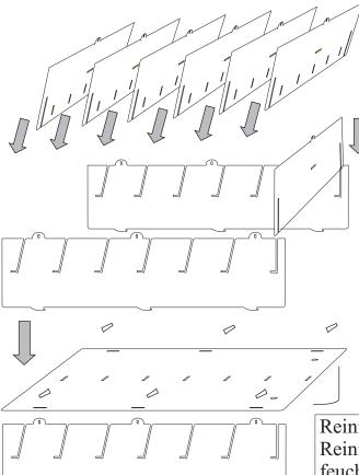
Vor der Montage zuerst die Schutzfolie entfernen. (beidseitig) Danach werden die Regalböden in die Regalseiten eingeschoben.
