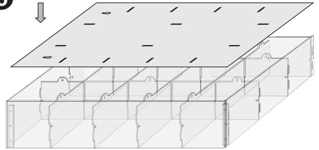
Abschließend wird die Rückwand 12200a aufgelegt und mittels Keilen fixiert. Sollen mehrere Regale nebeneinander aufgestellt werden, können Sie mit Hilfe der längeren M3 Schrauben verbunden werden.
