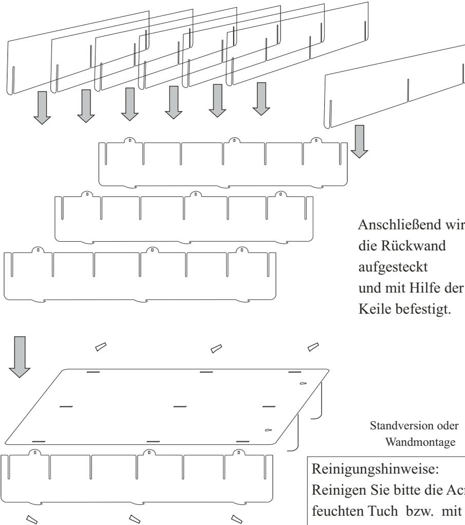
Anschließend wird die Rückwand aufgesteckt und mit Hilfe der Keile befestigt.
